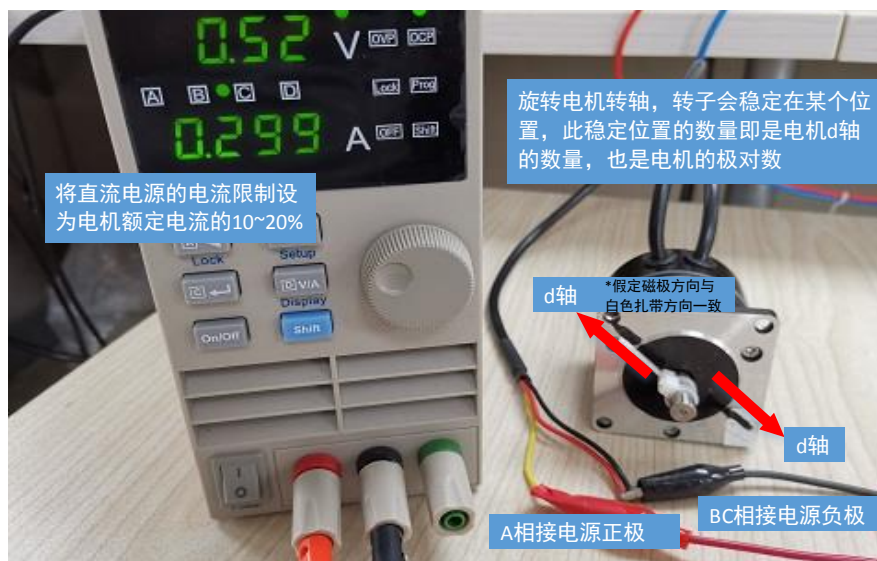
图 1 转子极对数（数量较少时）的测量方法
